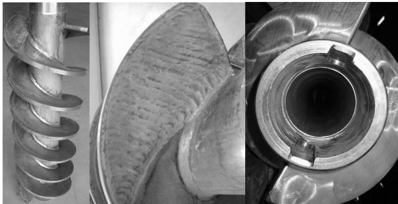
Abb.13-12: Schnecke mit gepanzertem Spezialwerkstoff und Nabenaufnahme, Neuzustand
