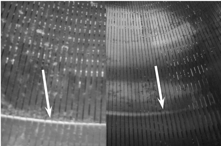
Abb.13-9 : Verschleiß im Sieb durch verspanntes Sieb (links)
