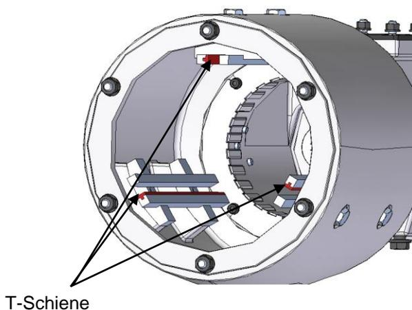
Abb. 13-5 Gehäuse Separator PSS 1.1-300 mit Siebführungsschienen und T-Kunststoffprofiltschienen
