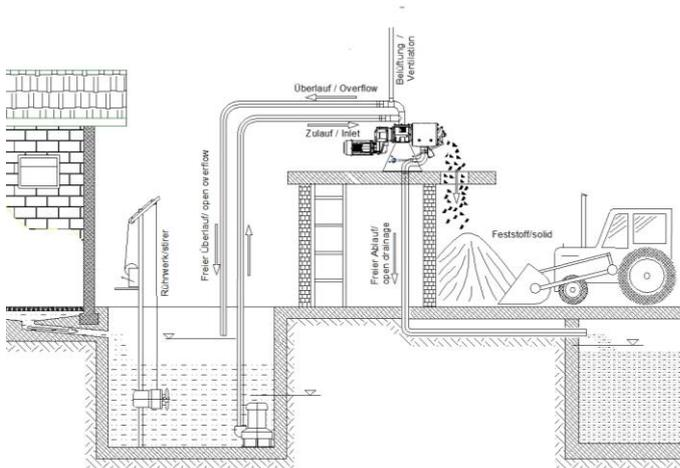
Abb.4-5 Beschickung über Pumpe
