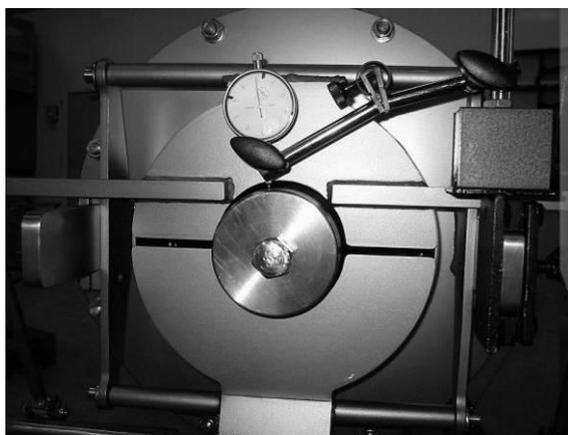
Abb. 13-13: Kontrolle des Taumelschlags der Schnecke
